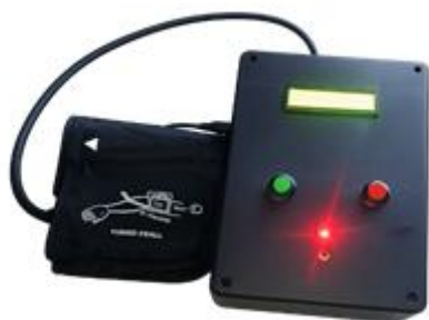
Gambar 3. Prototipe sistem monitoring tanda vital kesehatan berbasis ESP32.
