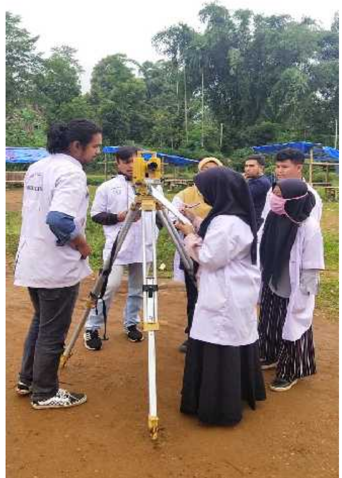
Gambar 2 pengukuran lokasi menggunakan theodolite
