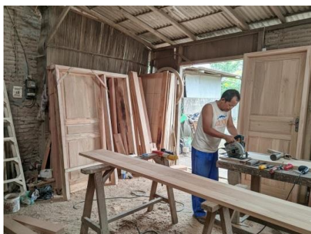
Gambar 2. Lokasi PKM dan pekerja yang tidak memakai APD dalam proses pemotongan kayu.
