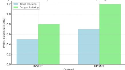
Gambar 5. Perbandingan Waktu Eksekusi Operasi INSERT dan UPDATE
