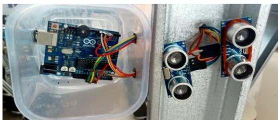
Gambar 4 Hasil Rangkaian Sensor Ultrasonik
